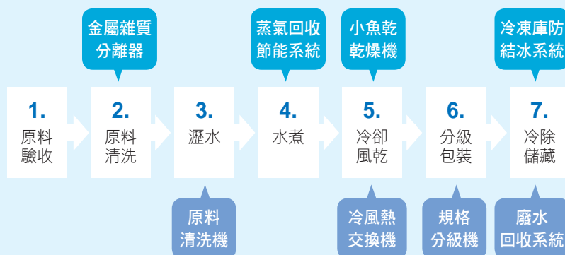
圖1 漁獲產品加工流程與加工設備 (溪和食品有限公司，科技農企業菁創獎，2012)
