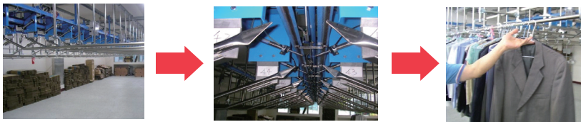
圖九 後端送洗衣物可程式電腦化自動分桿作業
